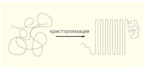
Рис.13. Схема кристаллизации полимера путем складывания индивидуальных цепей.
